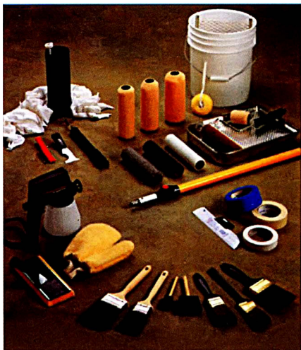
↑ Малярные инструменты и приспособления: ведро с сетчатым фильтром грубой очистки, малярный лоток, валики, удлинительный шток, набор для очистки валиков, ветошь, щётка, малярная лента трёх видов, брызгозащитный экран, кисти с синтетической и натуральной щетиной, распылитель низкого давления, губчатая швабра, малярная рукавица.
